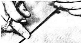
**B.** Sind längere Leiterbahnen zu ziehen, sollten Sie mit dem Zeigefinger auf dem Band nachfahren, bevor es abgeschnitten wird.
