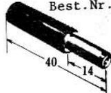
**ND-404** Netzteilstecker, 2-polig, koaxial, 2,5 mm Bohrung, lange Ausführung
