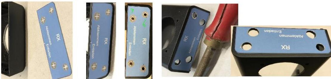
Etikette an der schwarzer Linie ausschneiden und an die obere Stirnseite kleben. Bohrungen mit 3mm vorbohren und dann auf 6mm und 7mm Erweitern. Mit einer Rundfeile die Löcher glätten.
