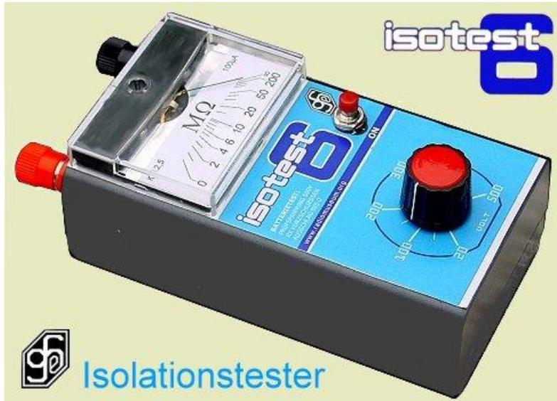
Isolationstester zum Ermitteln des Leckstromes von Kondensatoren (keine Elkos) mit Prüfspannungen von 20-500V.
