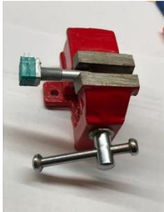
Achse mit Metallsäge schneiden.
