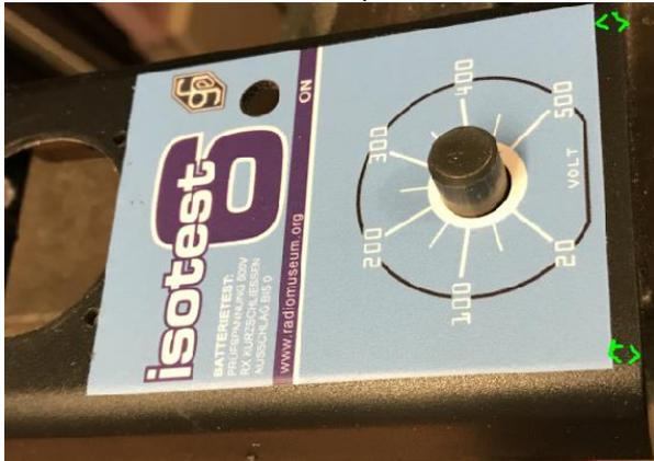
Die Bohrung für den Taster muss nicht ganz genau passen. **Wichtig:** Etikette Parallel zum unteren Rand und genau zum 7 mm Loch (Poti) . Beim 7mm Loch (Taster) etwaige überstehende Folie mit Feile entfernen. Das wird später von der Befestigungsmutter des Tasters überdeckt. Den Überstand beim Ausschnitt für das Instrument, mit einem stumpfen Messer oder einer Schere entfernen.
