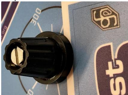
Freiraum unter dem Knopf mit einer Etikette prüfen. Der Knopf darf nicht an der Frontplatte scheuern.
