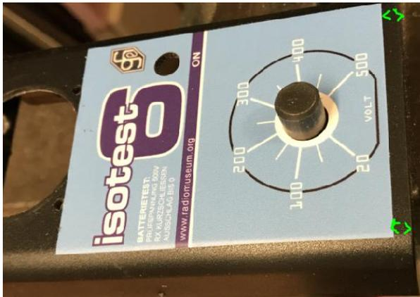
Die Bohrung für den Taster muss nicht ganz genau passen. **Wichtig:** Etikette Parallel zum unteren Rand und genau zum 10mm Loch. Beim 7mm Loch etwaige überstehende Folie mit Feile entfernen. Das wird später von der Befestigungsmutter des Tasters überdeckt. Den Überstand beim Ausschnitt für das Instrument, mit einem stumpfen Messer oder einer Schere entfernen.
