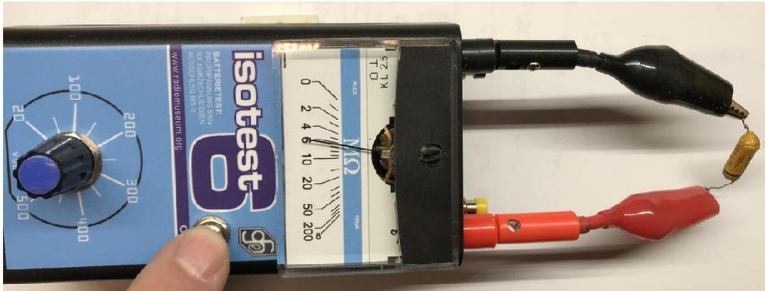
Der Kondensator ist defekt obwohl ein Bauteiletester den noch bei 50nF anzeigt, aber das ist ja bekannt.
