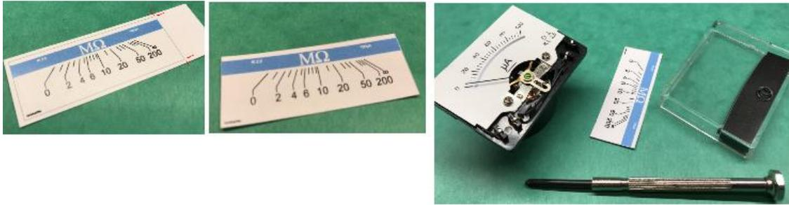
Zwei Schrauben lösen, Blechskala in Pfeilrichtung unter dem Zeiger abziehen
