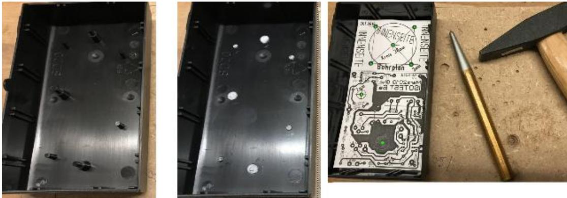
Das sind 7 Bohrungen, welche mit 3mm von **innen** nach außen gebohrt werden. Hier liegt die Frontplatte eben auf der Unterlage auf und der Bohrer verläuft nicht, da der Kunststoff weich ist. Nachher auf den gewünschten Durchmesser aufbohren.
