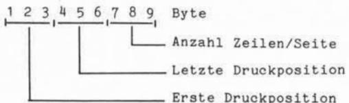
Beim Einsatz eines Zeilendruckers werden die erste und die letzte Druckposition nicht ausgewertet. Die letzte
